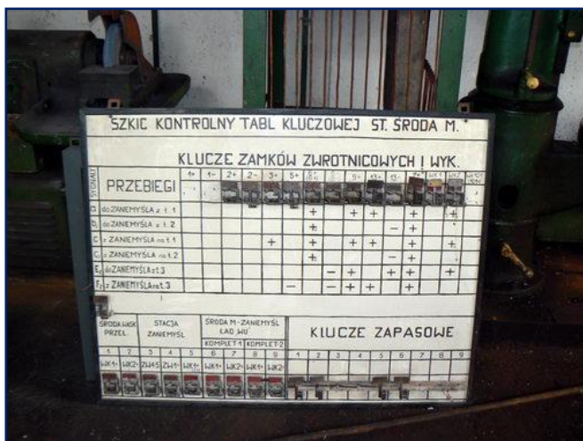
Tablica z wzorami zamków zwrotnic stacji Środa Miasto i Środa Wąskotorowa.
